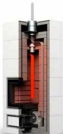
Obenanschluss, Anheizschieber geschlossen
