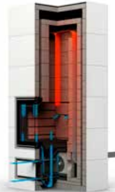
Luftzufuhr von Aufstellraum
